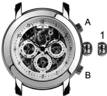
Remonter la montre pour la faire démarrer, en tournant la couronne 30 à 40 fois. Tirer la couronne avec précaution sur position 1. Régler sur 7 heures, en tournant le remontoir dans le sens inverse des aiguilles. Régler ensuite le jour à l'aide du poussoir A. Le poussoir B sert à régler la date. Régler ensuite l'heure exacte en tournant le remontoir dans le sens inverse de fonctionnement des aiguilles. Puis renfoncer la couronne.
