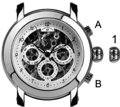
Door de kroon 30 tot 40 keer op te draaien activeert u het horloge voldoende. Door de kroon in stand 1 uit te trekken stelt u de urenwijzers op 7 uur in, door de kroon tegen de klok in te draaien. Vervolgens kunt u met pusher A de actuele dag instellen. Met pusher B stelt u de datum in. Stelt u alleen de urenwijzers in door met de kroon tegen de klok in te draaien. Hierna de kroon weer indrukken.
