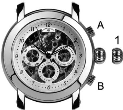
Ruotare la corona almeno 40 volte. In questo modo il bariletto viene caricato. Mettere la corona in posizione 1 sollevandola di una tacca. Regolare l'ora sulle sette girando la corona in senso anti-orario. Premere il pulsante A per regolare il giorno. Premere il pulsante B per regolare la data. Posizionare le lancette sull'ora desiderata, girando la corona in senso anti-orario e rimettere la corona nella posizione iniziale.
